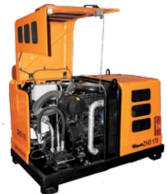
Агрегат может крепиться на 3-точечной системе навески II категории (ТСН) или работать как стационарное устройство
