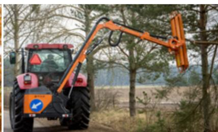
WWT700T, WWT800T - большой диапазон работы благодаря раздвигающемуся с помощью телескопического цилиндра плечу
